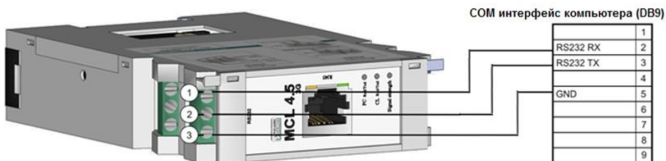
Рис. 4.5. Подключение контроллера MCL 4.5 к компьютеру через интерфейс RS232
