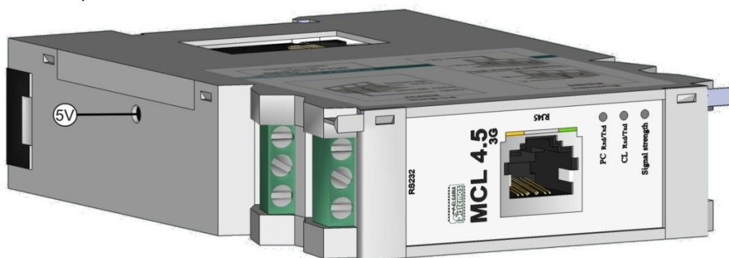
Рис. 4.4. Схема подключения питания к контроллеру MCL 4.5
